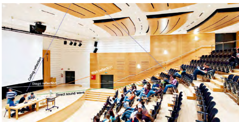
Aula magna scuola superiore «Gasteiner», Bolzano – Suono diretto, riflessioni laterali, a soffitto etc Acustica C. Niederstätter, D. Baumann, M. Lanfranchi (Fig. 11)
