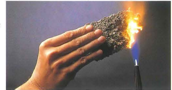
Ein eindrucksvolles Beispiel für die minimale Wärmeleitfähigkeit von Roma Vita. Gut als Brandschutz (und ebenso gut für die Wärmedämmung).
