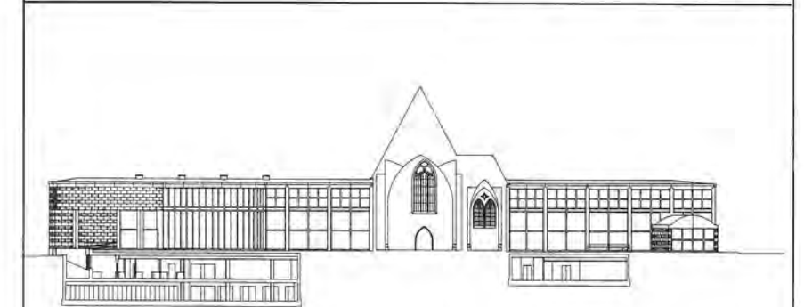
Prospetto sul cortile e sezione sui piani interrati Courtyard elevation and section through basement floors
