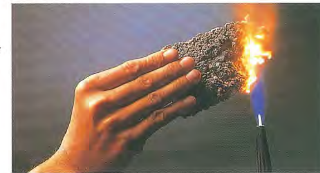
Ein eindrucksvolles Beispiel für die minimale Wärmeleitfähigkeit von Roma Vita. Gut als Brandschutz (und ebenso gut für die Wärmedämmung).
